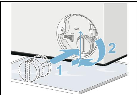
8. Service-Klappe einsetzen und einrasten.
