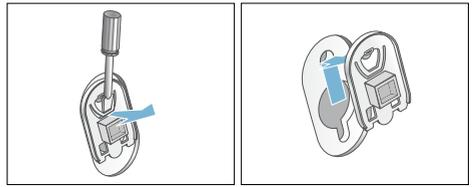
2. Alle 4 Hülsen einsetzen. Netzleitung an den Halterungen festklemmen. Schrauben einsetzen und mit einem Schraubenschlüssel SW13 festziehen.
