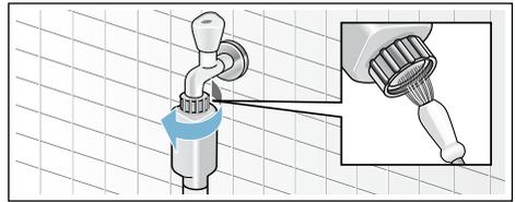
6. Sieb einsetzen, Schlauch anschließen und auf Lecks prüfen.
