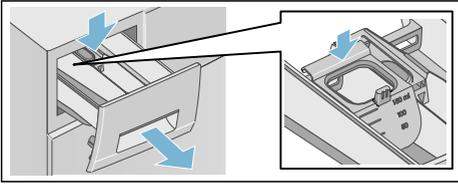
**Hinweis:** Verwenden Sie die Dosierhilfe nicht bei gelartigen Waschmitteln und Waschpulver und bei Programmen mit Vorwäsche bzw. gewählter "Fertig in"-Zeit.
